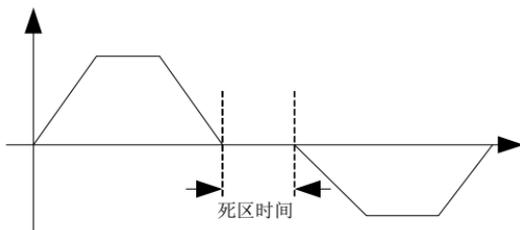
图 6-14. 正反转死区时间示意图
