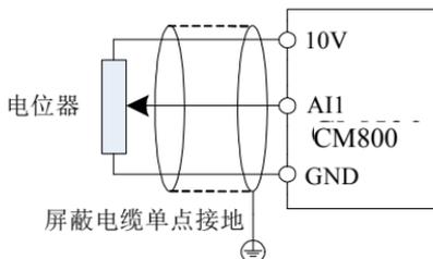
图 3-3. 模拟量输入端子接线示意图
