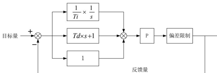
图6-23. 过程PID原理框图
