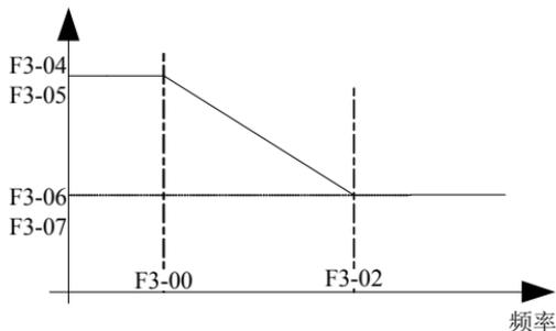
图 6-6. 速度环 PI 参数切换示意图
