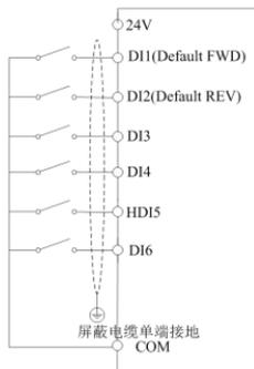
DI接线模式二：当DI拨码开关为NPN模式使用外部电源
