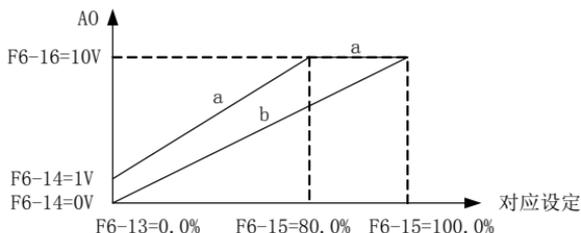
图6-12. 模拟输出上下限对应关系
