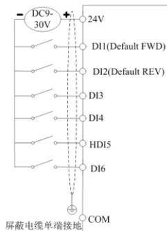
DI接线模式三：当DI拨码开关为PNP模式没有使用外部电源
