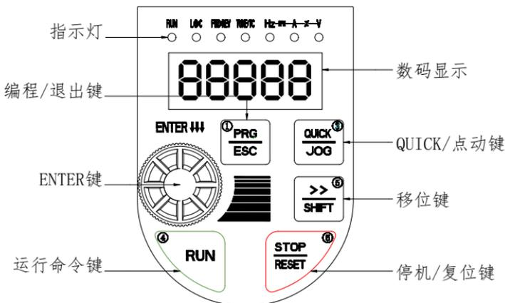
图4-1. LED旋钮键盘（11.0kW及以上变频器标准配置）
