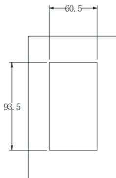
图2-8. 外引键盘带托盘安装开孔尺寸
