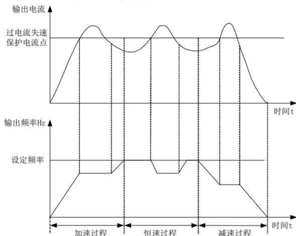
图6-22. 过流失速保护示意图
