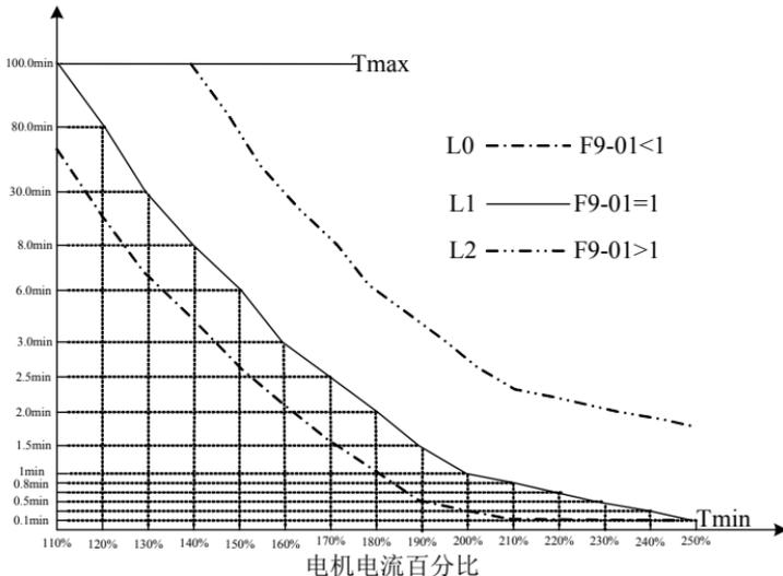
图6-21. 电机过载保护曲线
