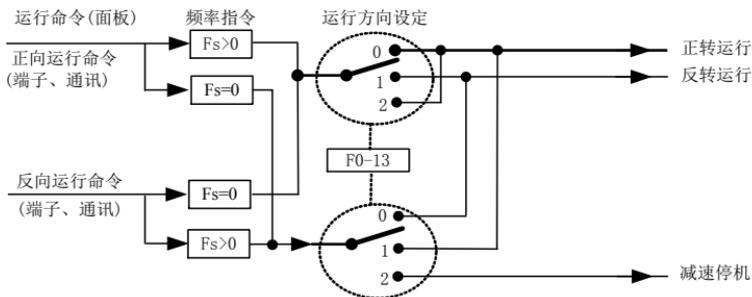
图4-22. 电机运转方向示意图
