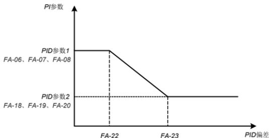
图6-24. PID参数切换
