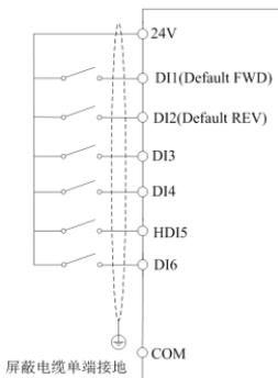
DI接线模式四：当DI拨码开关为PNP模式使用外部电源
