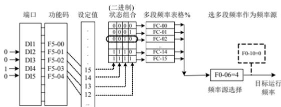
图4-21. 多段速控制示意图
