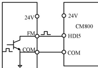
高速脉冲接线模式二：当DI拨码开关为NPN模式使用外部电源
