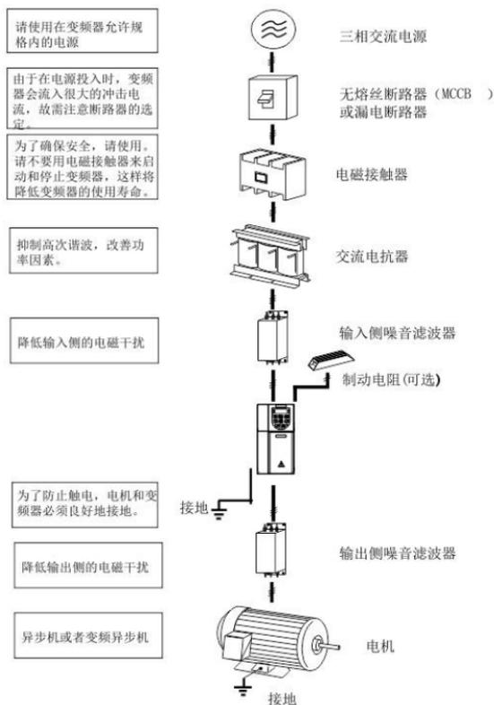
图 1. 与外围机器的连接示例
