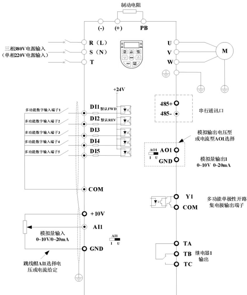
图 3-1. 三相 (380V) 变频器  $\leq 9.0\text{kW}$
