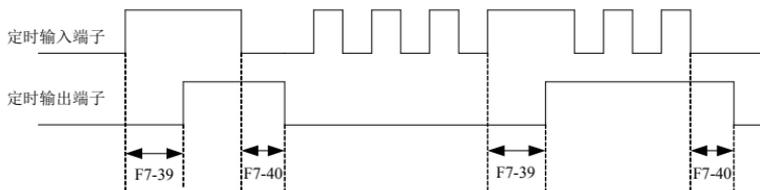
图 6-19. 定时器输入输出动作简图
