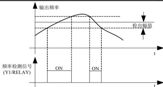
图 6-16. 频率到达检出幅值示意图
