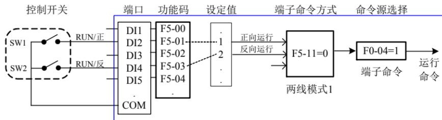
图4-8. 端子控制启停示意图
