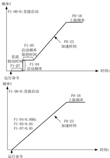
图4-11. 直接启动示意图
