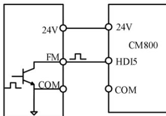
高速脉冲输入输出作为多台变频器之间的同步控制，常用模拟输入，输出进行同步控制，性能更好，调试更方便。
