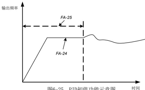
图6-25. PID初值功能示意图
