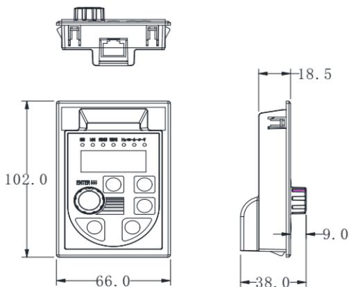
图2-7. 外引键盘带托盘安装尺寸图
