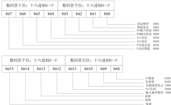
图 6-18. LED 停机显示对应图
