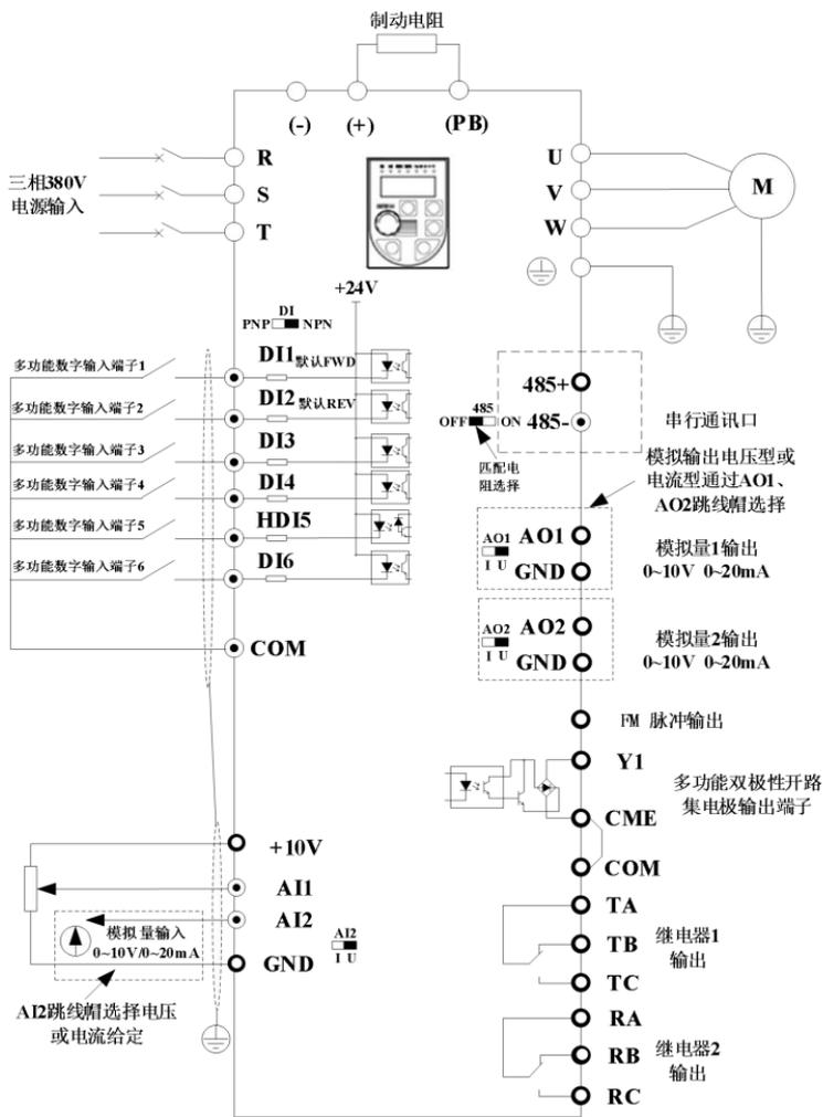
图3-2. 三相变频器（380V）11kW及以上（通用型）
