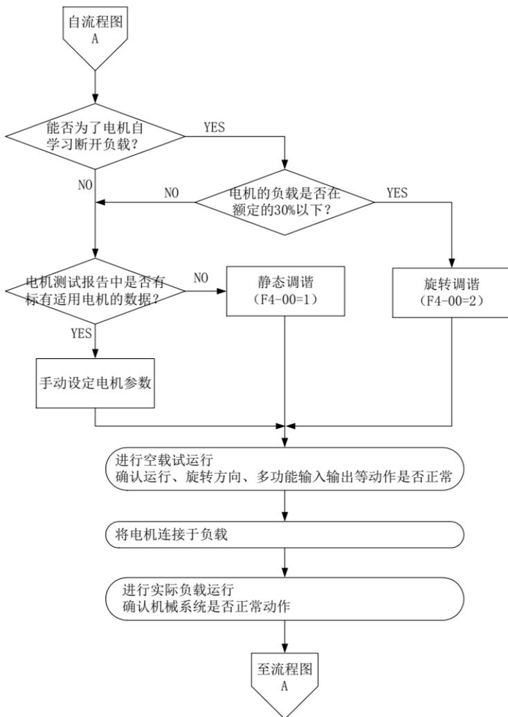
图 4-6. 开环矢量控制方式运行步骤
