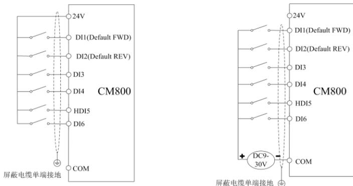
图3-4. 四种不同模式下数字输入端子接线图
