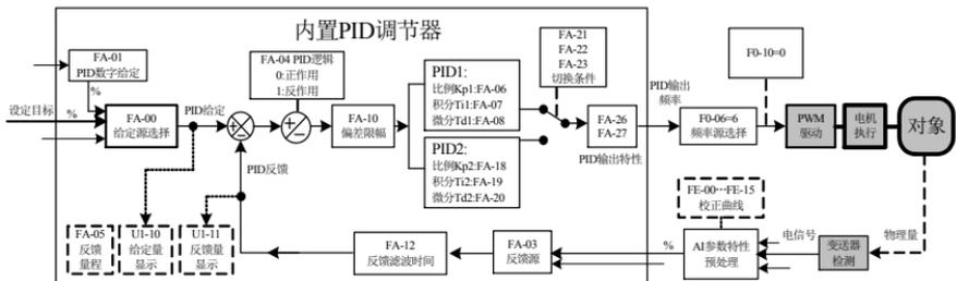
图4-19. 频率闭环控制示意图
